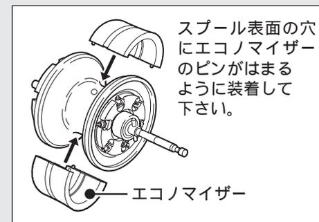
スプール表面の穴にエコノマイザーのピンがはまるように装着して下さい。
